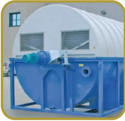
El sistema de oxidación biológica aprovecha uno o más discos rotativos para la eliminación de la sustancia orgánica contenida en las aguas residuales. Cada rodillo se compone de un árbol en el cual se insertan discos de Polipropileno de número variable dependiendo del modelo.
